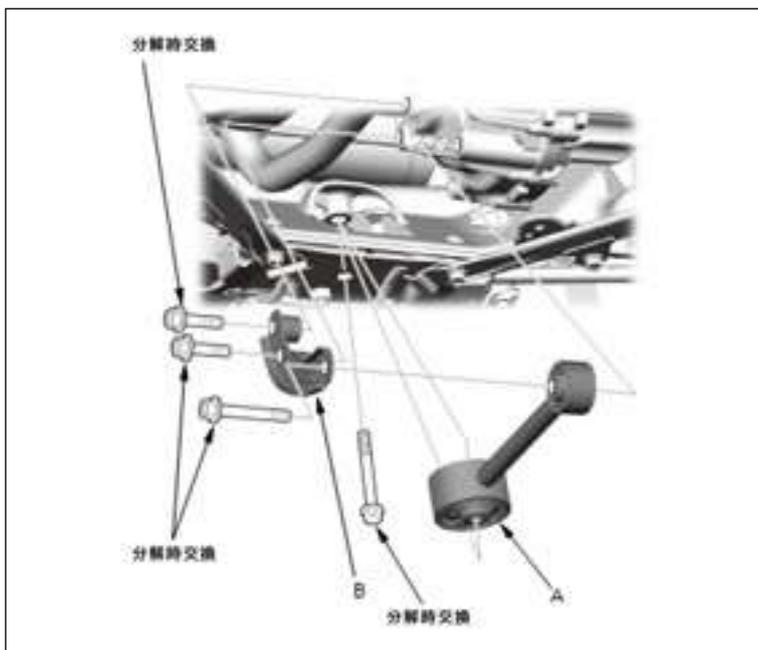
トランスミッションを材木やゴム等の当て板で軽く支えてエンジンマウント（トルクロッド）のボルトを外しエンジンを後方に押しながら取り外します。
