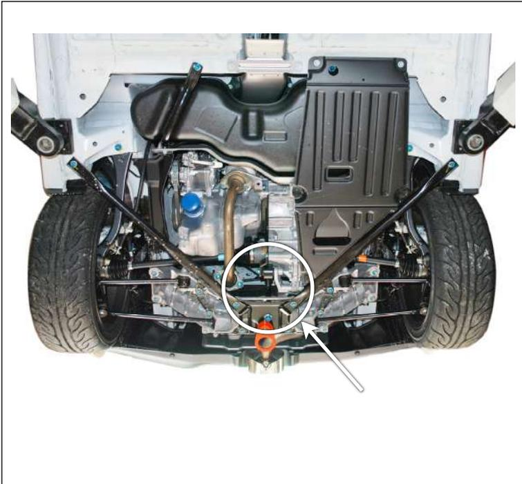
左図○で囲った部分のエンジンマウント（トルクロッド）を交換します
