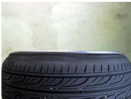
タイヤの適用リム幅以上のホイール選択、組み付けをし走行していた例です。
