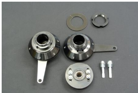
ボディ本体部はアルミA6063材を切削加工にて成形。 スライドプレート部はスチールになります。
