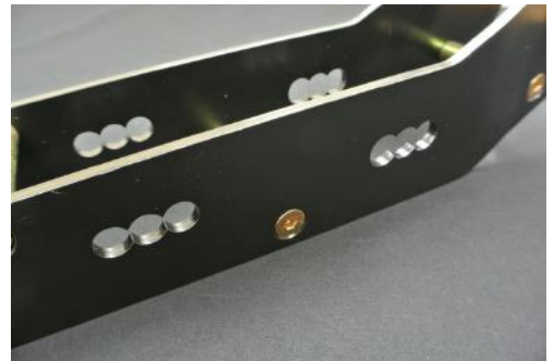
ショックアブソーバー取付穴、スタビライザーリンク 取付穴を三段階で変更可能。 取付角の補正が可能です。
