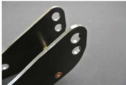
ナックル側取付穴は純正比-25mm位置と -45mm位置の二箇所設け、ローダウン仕様となります。
