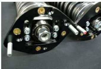
フロントアップアマウントはジュラルミン製プレートにNMB製ピロボール採用。リペアも容易です。また、キャンバー調整だけでなく、ノーマル/ハイカスター切り替えプレートを装備しています。
